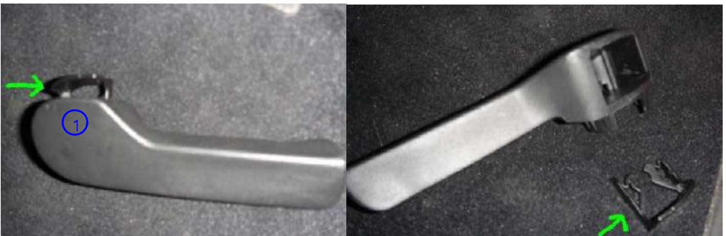
Il faut d'abord déclipper le verrouillage de la poignée, à l'aide d'un tournevis plat. (1)
