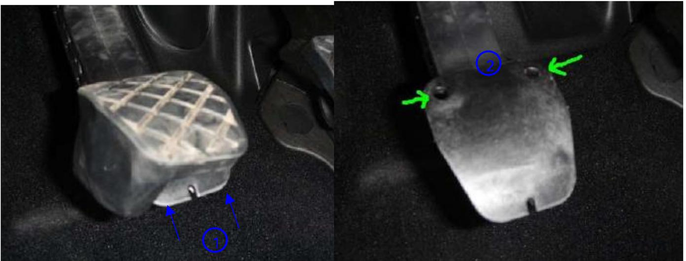
Relever le caoutchouc de la pédale d'embrayage, en le tirant vers le dessus, en partant de la partie la plus proche du siège conducteur (1)
