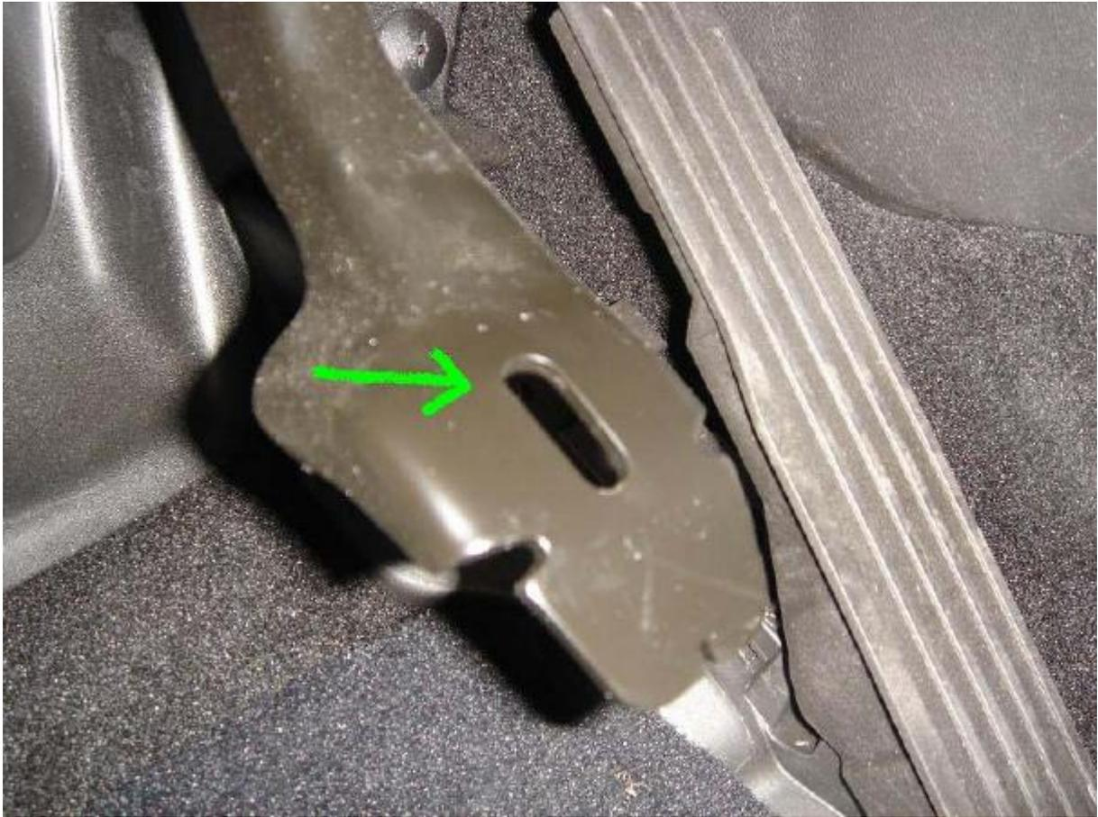
Relever le caoutchouc de la pédale de frein, en le tirant vers le dessous, en partant de la partie la plus proche du siège conducteur. (idem à la pédale d'embrayage)
