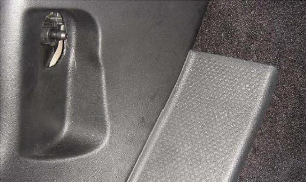
Ensuite, soulever le plastique des bas de portes (celui qui recouvre la moquette) et le déclipper (flèche rouge). (2)
